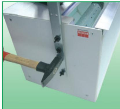
Befestigungsstiel ① anlegen, Kunststoffdübel ② liegen auf der Bohrung. Durch Hammer Schlag auf den Stiel ② die Dübel im Kopfstück fixieren. Achtung: den Stift nicht noch nicht einschlagen!
